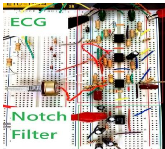
圖 4. 心電圖分析儀實際硬體電路
