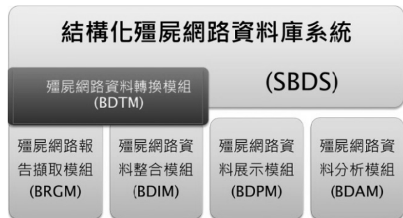
圖4. 結構化殭屍網路資料庫系統架構
